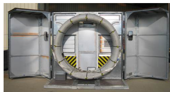
Conteneur spécifique pour pièce habillage moteur A320 NEO.
